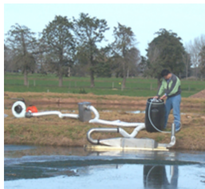
Figura 5: Túnel de vento projetado pela UNSW em funcionamento.
